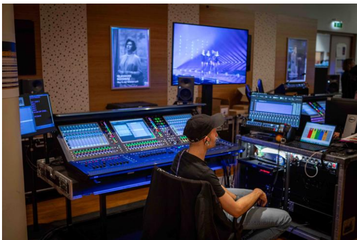
Ausfallsicherheit hatte beim ESC oberste Priorität – hier eines von zwei unabhängigen Monitorpulten
